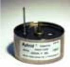
Серия THQ4 имеют такую же ёмкость, как серия THQ5 но в немного более коротком и лёгком корпусе. Имеют большую ёмкость, низкий ESR, способность отдать большой ток. Температурный диапазон: -55..125°C.
