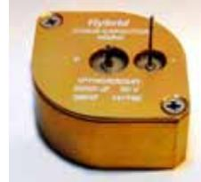
Конденсаторы THQ3 могут выпускаться в исполнении с дополнительным анодированным алюминиевым кожухом. Корпус заполнен защитным компаундом. Данное исполнение пригодно для применений в условиях высокой вибрации где конденсатор должен быть очень жестко закреплён.
