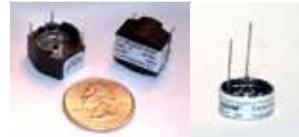
Серия THQA2 оптимально приспособлена для военных и аэрокосмических применений, требующих высокую мощность в компактном, герметичном танталовом корпусе. Применения включают в себя импульсную накачку, фильтрацию, резервные источники питания. Температурный диапазон: -55..125°C.
